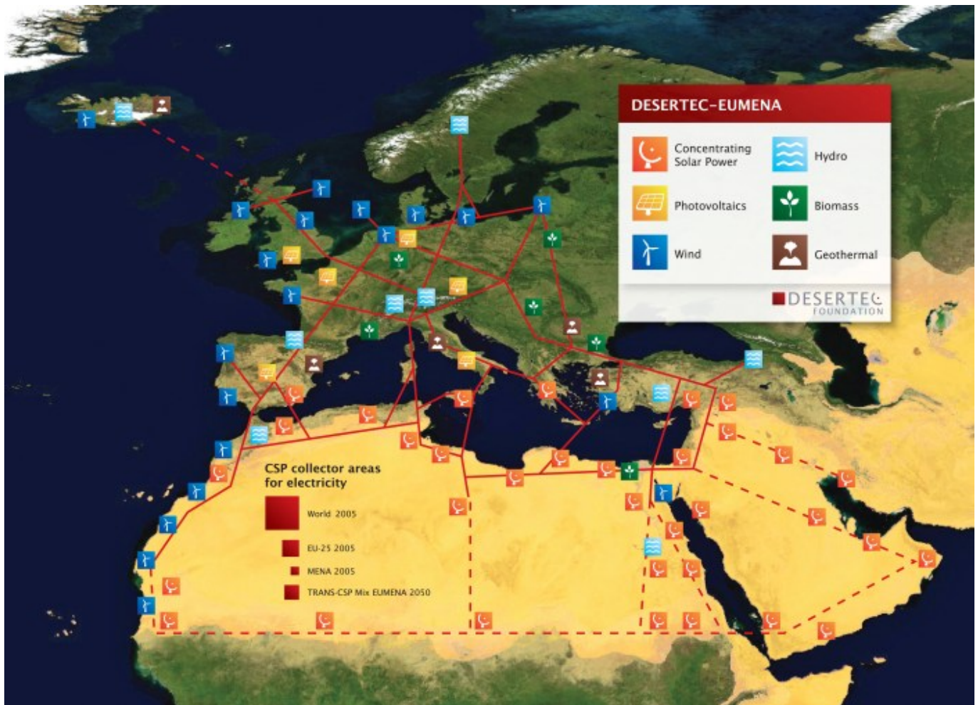
Desertec Foundation : Skizze einer möglichen Infrastruktur für eine nachhaltige Stromversorgung in Europa, dem Nahen Osten und Nord-Afrika (EU-MENA). Erzeugt werden soll genügend Energie, um den Bedarf an Meerwasserentsalzung und zwei Drittel des bis 2050 stark wachsenden Strombedarfs der MENA-Region zu decken sowie etwa 17 Prozent des europäischen Strombedarfs. (Bild: wikimedia commons)
